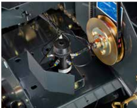
5. Automatische BEKA-MAX Kettenschmierung
