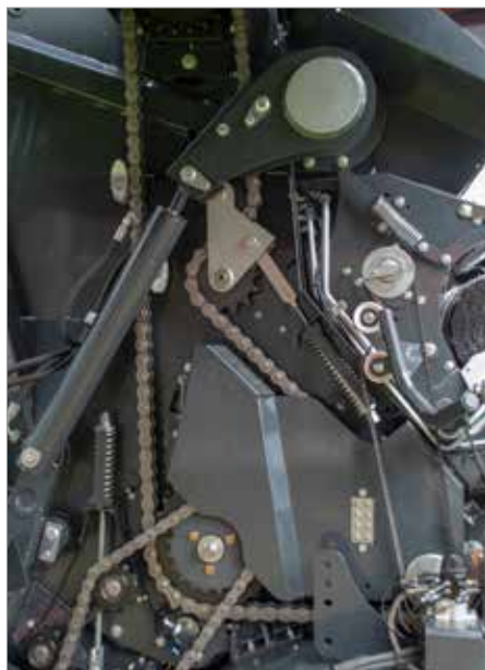
8. Robuster Antrieb mit verschleißfesten, groß dimensionierten Ketten
