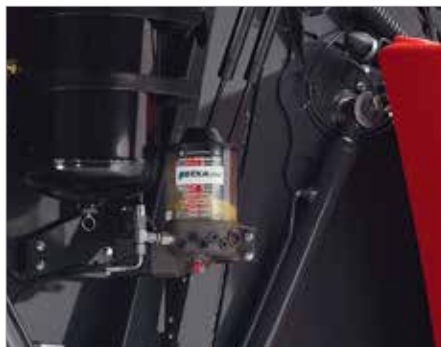
10. Serienmäßige automatische BEKA-MAX Zentralschmierung
