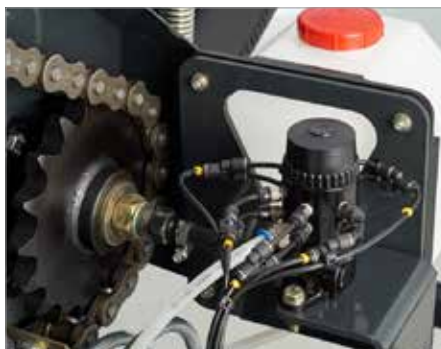
6. Automatische BEKA-MAX Kettenschmierung
