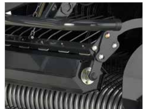
4. Großer Rollenniederhalter mit Prallblech (Ø 217 mm)
