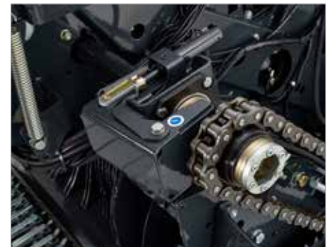
4. Serienmäßige hydraulische Rotorentkopplung
