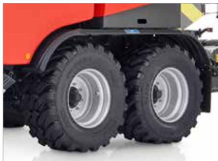
9. XL-Tandemachse mit Bereifung 500/60R22.5
