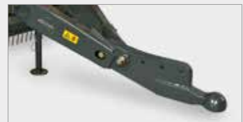
Mehrere Anhängemöglichkeiten, auch mit Kugelkopfkupplung 80 mm (K80)
